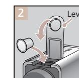
2. 開閉レバーを垂直まで上げてネスプレッソ専用カプセルをカプセル投入口にセットします。
