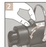
2.レバーを引き上げ、カプセルを投入口にセットしてください。
